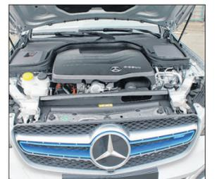
Blick in den Motorraum eines mit Brennstoffzellen betriebenen Autos. Foto: Nagengast
